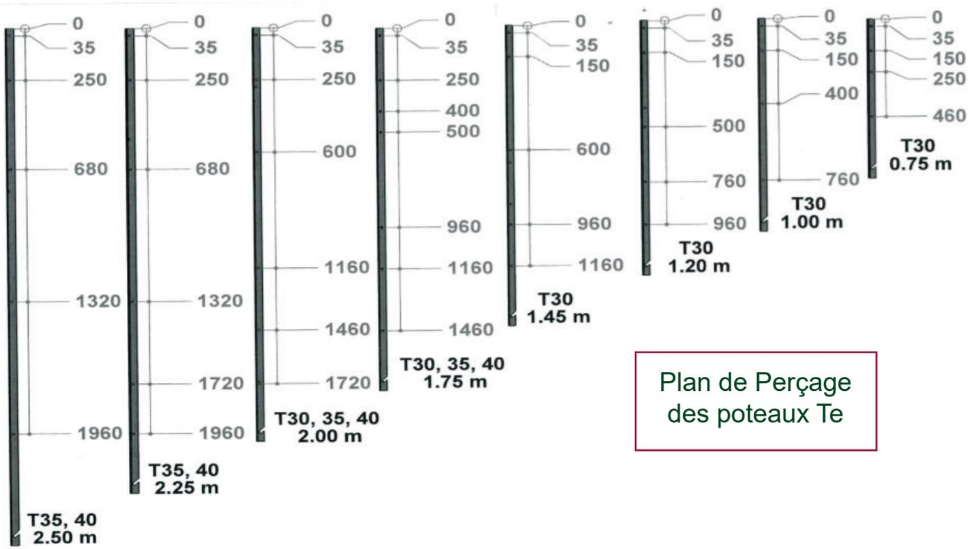
Plan de Perçage des poteaux Te
