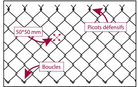
Notre grillage Simple Torsion est galvanisé au minimum à hauteur de 40g au M<sup>2</sup>.
